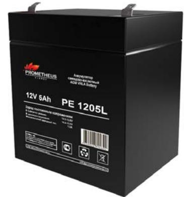
Свинцово-кислотные аккумуляторы **Prometheus Energy** серии PE являются ярким примером герметизированных, необслуживаемых батарей с системой рекомбинации газов (VRLA), произведенных по AGM технологии (электролит, абсорбированный в стекловолоконном сепараторе)
